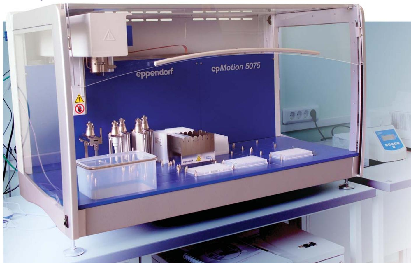
Пробоподготовка: станция epMotion.
