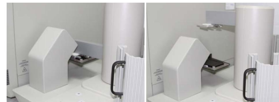
Рис. 2. Автоматическое устройство для подачи планшет.
