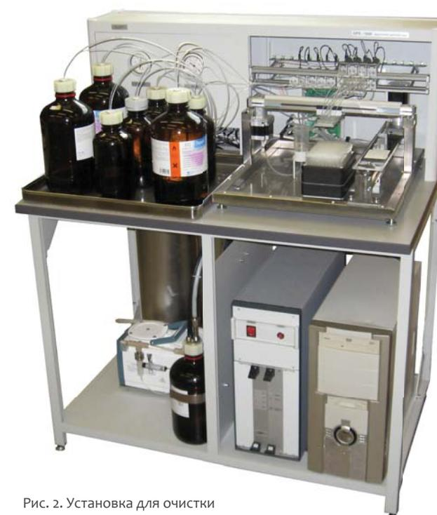
Рис. 2. Установка для очистки синтетических олигонуклеотидов.
