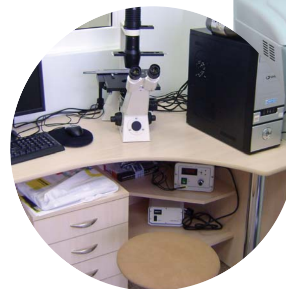
Инвертированный микроскоп Axiovert 40 (Zeiss) с бинокулярной насадкой и встроенным фронтальным фото/видеовыходом.
