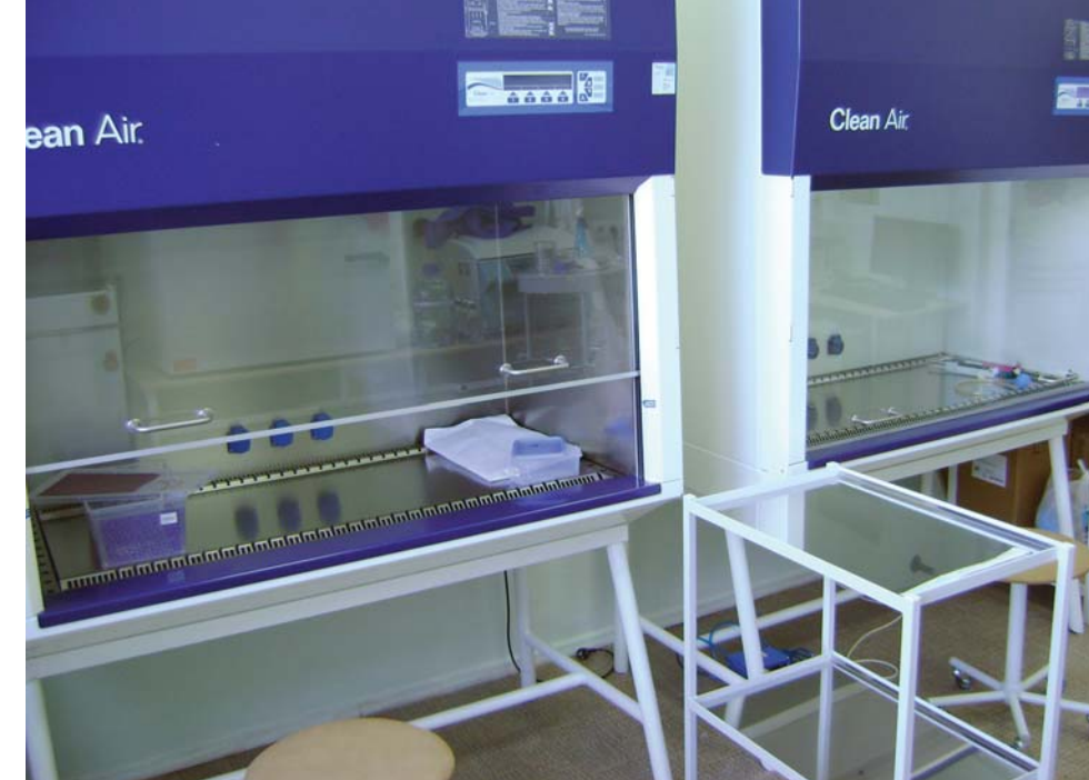
Стерильные боксы (Clean Air) для работы с культурами клеток и CO 2 -инкубатор (HERA cell 150 Thermo scientific).
