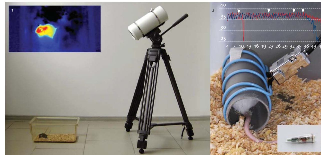
Система комплексного мониторинга поведенческих и температурных реакций животных, используемая при изучении эмоциональности, агрессии, когнитивных функций. Слева (1) – тепловизор ТКВр-СВИТ 101 (Институт физики полупроводников СО РАН); вверху – тепловое излучение мыши. Справа (2) – имплантируемый регистратор температуры тела (термохрон) и устройство для считывания данных, накопленных термохроном; вверху – динамика температуры тела у двух мышей в ходе эксперимента.
