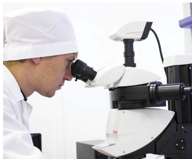
Комплект микроскопов Leica Microsystems (дуплет стереомикроскопов Leica M80, инвертированный микроскоп Leica DM IL LED, световой микроскоп для проходящего света Leica DM 2500, стереомикроскоп S8APO, флуоресцентный стереомикроскоп Leica M205 FA).
