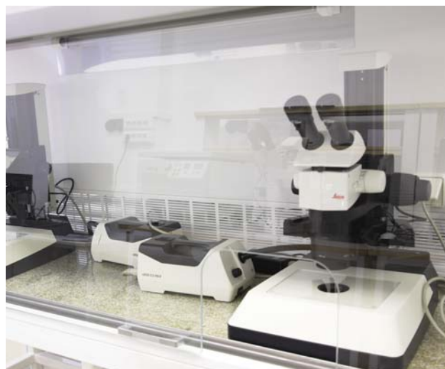
Комплект микроскопов Leica Microsystems (дуплет стереомикроскопов Leica M80, инвертированный микроскоп Leica DM IL LED, световой микроскоп для проходящего света Leica DM 2500, стереомикроскоп S8APO, флуоресцентный стереомикроскоп Leica M205 FA).
