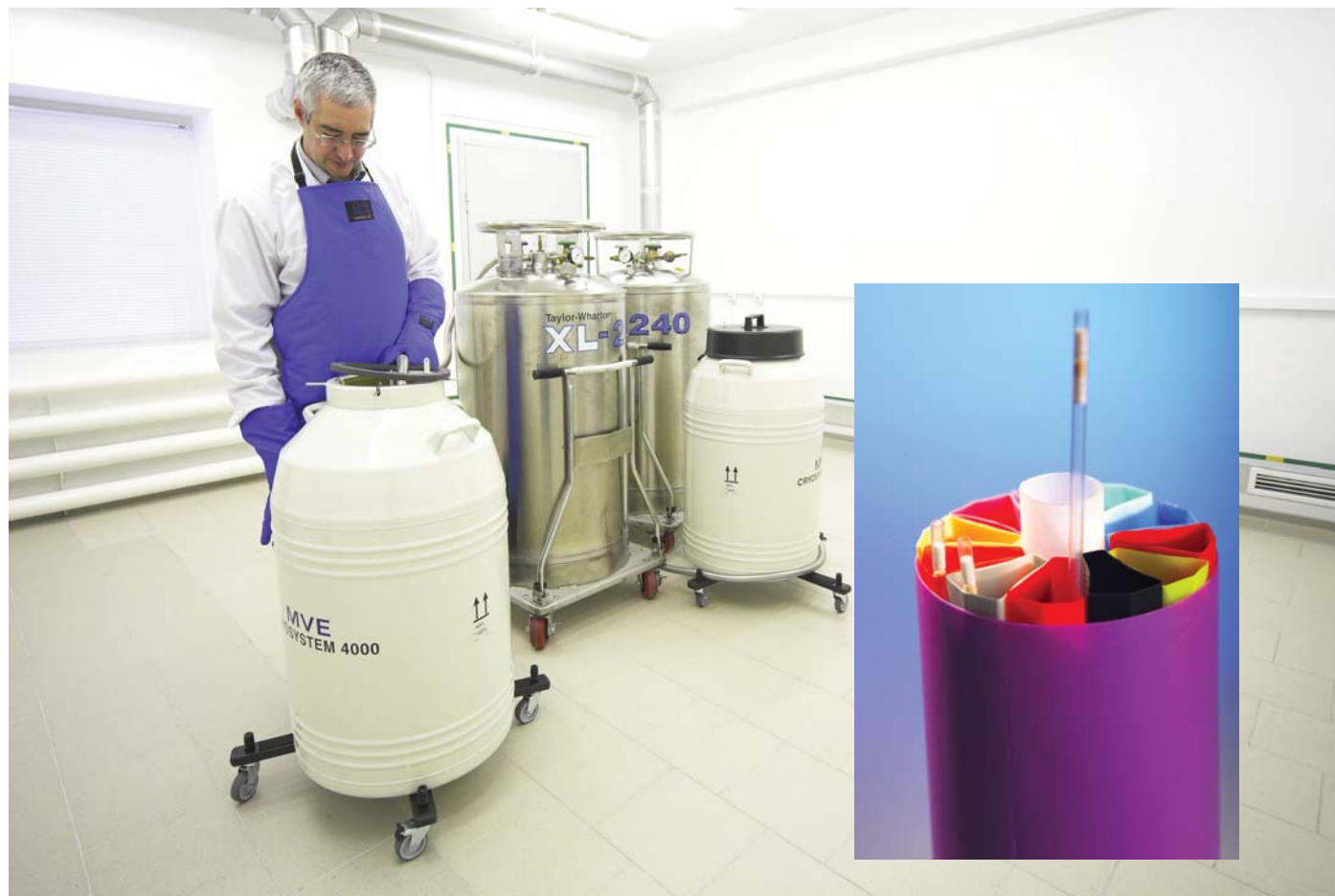
Криохранилище Cryosystem 4000, инвентарная система с набором соломин для эмбрионов и семени (MVE, США); резервуар криогенный 240-литровый (Taylor-Wharton International, США); программный замораживатель Cryogenesis V5 (CryoLogic, Австралия).
