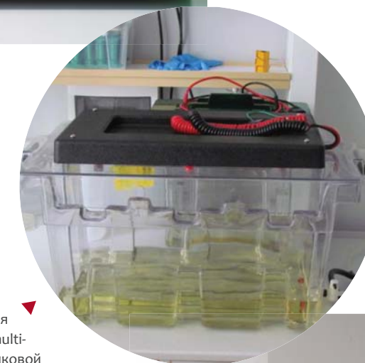
Рис. 1. Электрофоретическая ячейка PROTEAN IEF cell для разделения белковой пробы по заряду в тонкой полоске полиакриламидного геля с иммобилизованным градиентом pH – ReadyStrip IPG strips.
