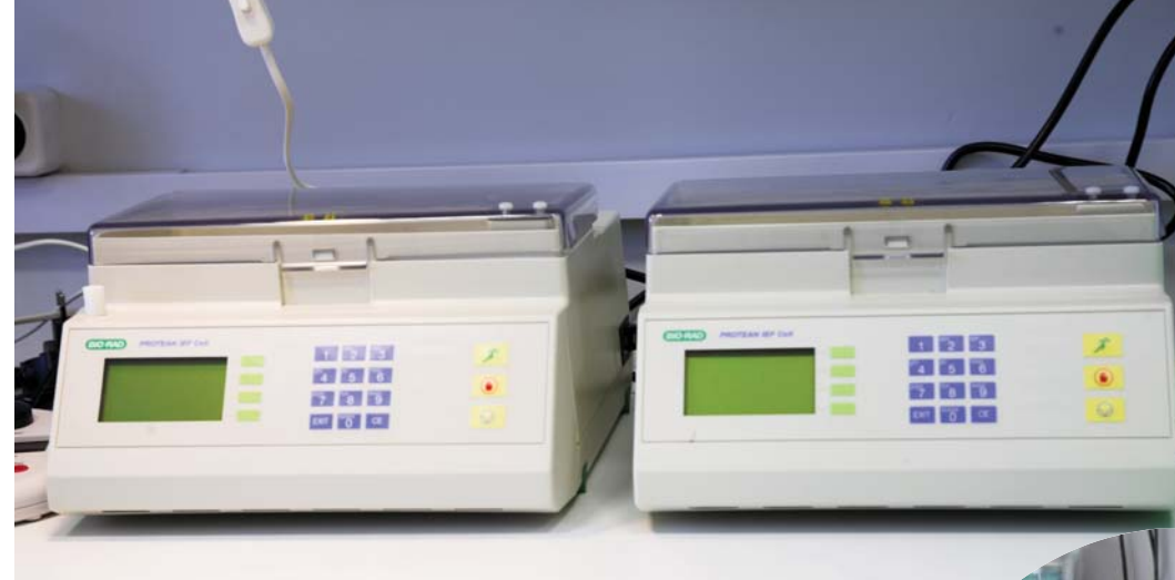
Рис. 1. Электрофоретическая ячейка PROTEAN IEF cell для разделения белковой пробы по заряду в тонкой полоске полиакриламидного геля с иммобилизованным градиентом pH – ReadyStrip IPG strips.
