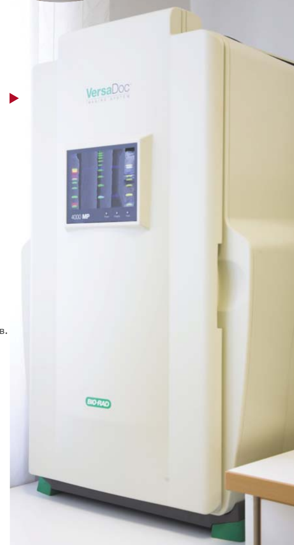
Рис. 3. Прибор VersaDoc MP 4000 для визуализации картины разделения белка в геле. При использовании специальных аналитических программ возможно проводить определение молекулярных весов, количественный и качественный анализ изменения экспрессии белковых образцов.
