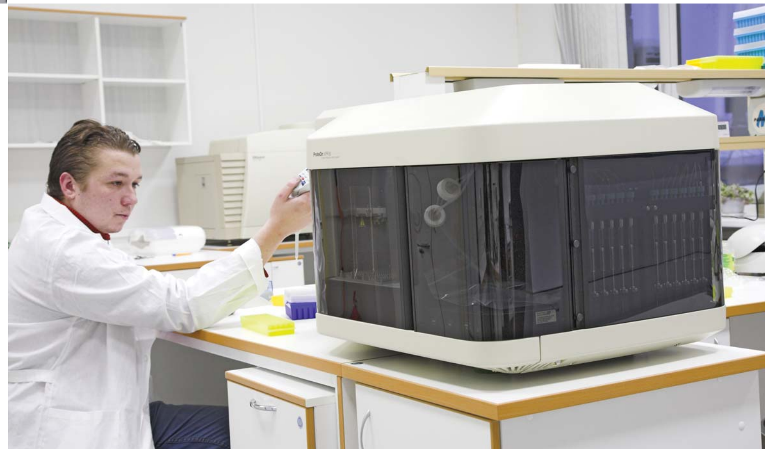
Рис. 8. Протеомный анализ с помощью оптического биосенсора BioRad ProteOn 36 на основе эффекта поверхностного плазмонного резонанса. Пригоден для скрининга и ранжирования в режиме реального времени антител, картирования эпитопов, изучения кинетики белок-белковых, белок-пептидных взаимодействий, взаимодействий белка с малыми молекулами и нуклеиновыми кислотами, проведения скрининга малых молекул.
