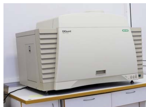
Рис. 4. Прибор EXQuest spot cutter – инструмент для точной локализации и вырезания белковых пятен либо полос из одно- или двумерных гелей или блотов. Вырезанные кусочки гелей или блотов помещаются автоматически в 96- или 384-луночные микроплашки для дальнейшей обработки и анализа.
