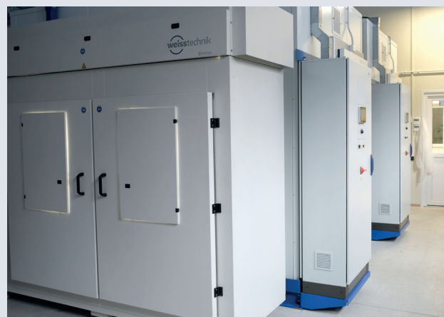
Климатическая камера для выращивания растений Fitotron HG1514 Module7 (Weiss Technik), 1,5 м 2 рабочей зоны. Предназначена для растений с высокой потребностью к свету, таких как пшеница, кукуруза, хлопок, рис
