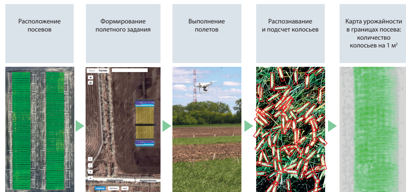
Схема оценки урожайности посевов пшеницы на основе анализа изображений, полученных с беспилотного летательного аппарата
