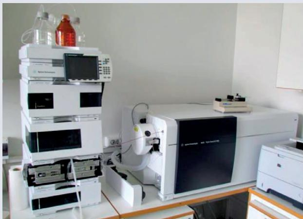
Система для анализа метаболитов Agilent 6430 Triple Quadrupole LC/MS
