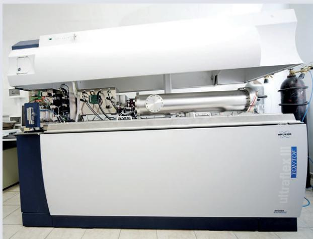
Масс-спектрометр Ultraflex ToF ToF (Bruker Daltonics), идентификация пептидов методом MALDI
