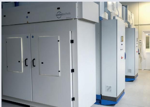
Климатическая камера для выращивания растений Fitotron HG1514 Module7 (Weiss Technik), 1,5 м<sup>2</sup> рабочей зоны. Предназначена для растений с высокой потребностью к свету, таких как пшеница, кукуруза, хлопок, рис
