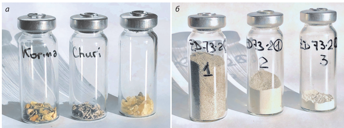
Рис. 4. Получение образцов порошковой камеди сортов гуара в лабораторных условиях: а – фракции зародыша (korma), семенной оболочки (shugi) и эндосперма, содержащего камедь; б – вид полученной в лабораторных условиях порошковой камеди после одной (1), двух (2) и трех (3) стадий очистки.
