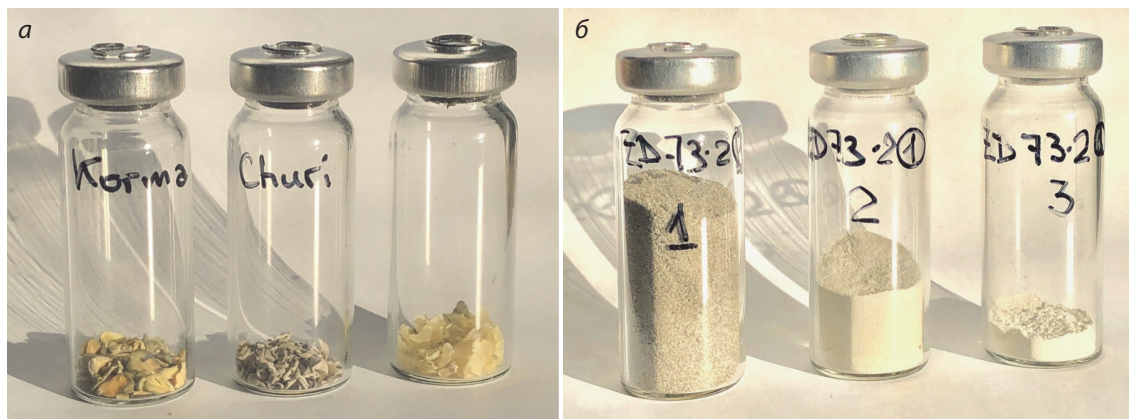
Рис. 4. Получение образцов порошковой камеди сортов гуара в лабораторных условиях: а – фракции зародыша (korma), семенной оболочки (shuri) и эндосперма, содержащего камедь; б – вид полученной в лабораторных условиях порошковой камеди после одной (1), двух (2) и трех (3) стадий очистки.
